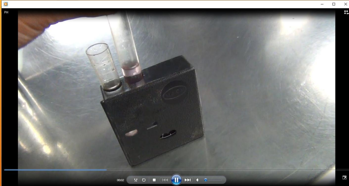
毎日、使用する水の残留塩素濃度を測っています。水質の安全性を確認してから調理に入ります。その他、厨房内の温度、湿度、冷蔵庫、冷凍庫の温度の測定と記録もします。
